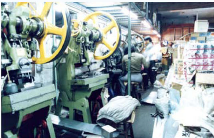
世如在新莊的第一家工廠，位在天泉路上，圖中設備為沖床。
